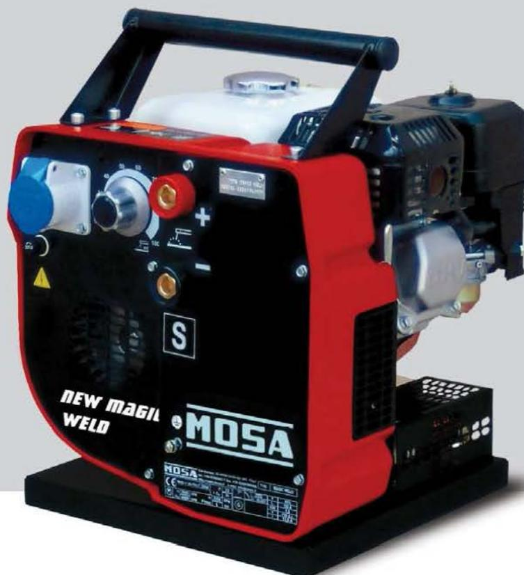
La motosoudeuse est un bloc avec un moteur, une structure en aluminium et un panneau frontal. Dans la structure il y a tous les composants électriques de la machine: un alternateur à aimant permanent, un pont diode "chopper" à haute fréquence, un tableau de commande électronique et un électro-aimant.
