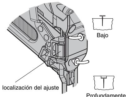
El Ajuste del Control de Fondo del Sujetador DIAL-A-DEPTH permite controlar minuciosamente el fondo de impulsión del sujetador, desde a ras con o justamente encima de la superficie de trabajo, a avellanado con poca o mucha profundidad. Primero, ajuste la presión de aire para lograr una impulsión consistente en el trabajo específico como se describe en la página 14; luego use el Ajuste del Control de Fondo del Sujetador para obtener la profundidad deseada de impulsión.
