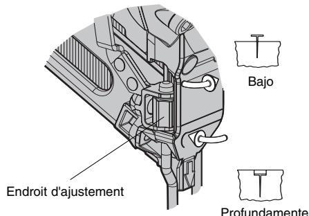
Le réglage de la profondeur de l'élément d'assemblage DIAL-A-DEPTH permet d'obtenir un contrôle précis de la profondeur de clouage; depuis le clouage à fleur, juste au dessus de la surface de travail jusqu'au fraisage peu profond ou profond. Tout d'abord, il faut régler la pression d'air pour une éjection régulière dépendant de la tâche spécifique, tel que décrit en page 24, puis utiliser le DIAL-A-DEPTH pour obtenir la profondeur de clouage désirée.
